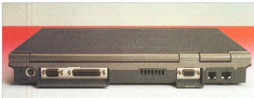
Sul retro, oltre alle connessioni classiche (PS2, porta parallela, porta seriale e uscita SVGA), troviamo il connettore del modem e quello della scheda di rete, la presenza di quest'ultima rende immediatamente l'idea del target elevato per cui è destinato il prodotto.
